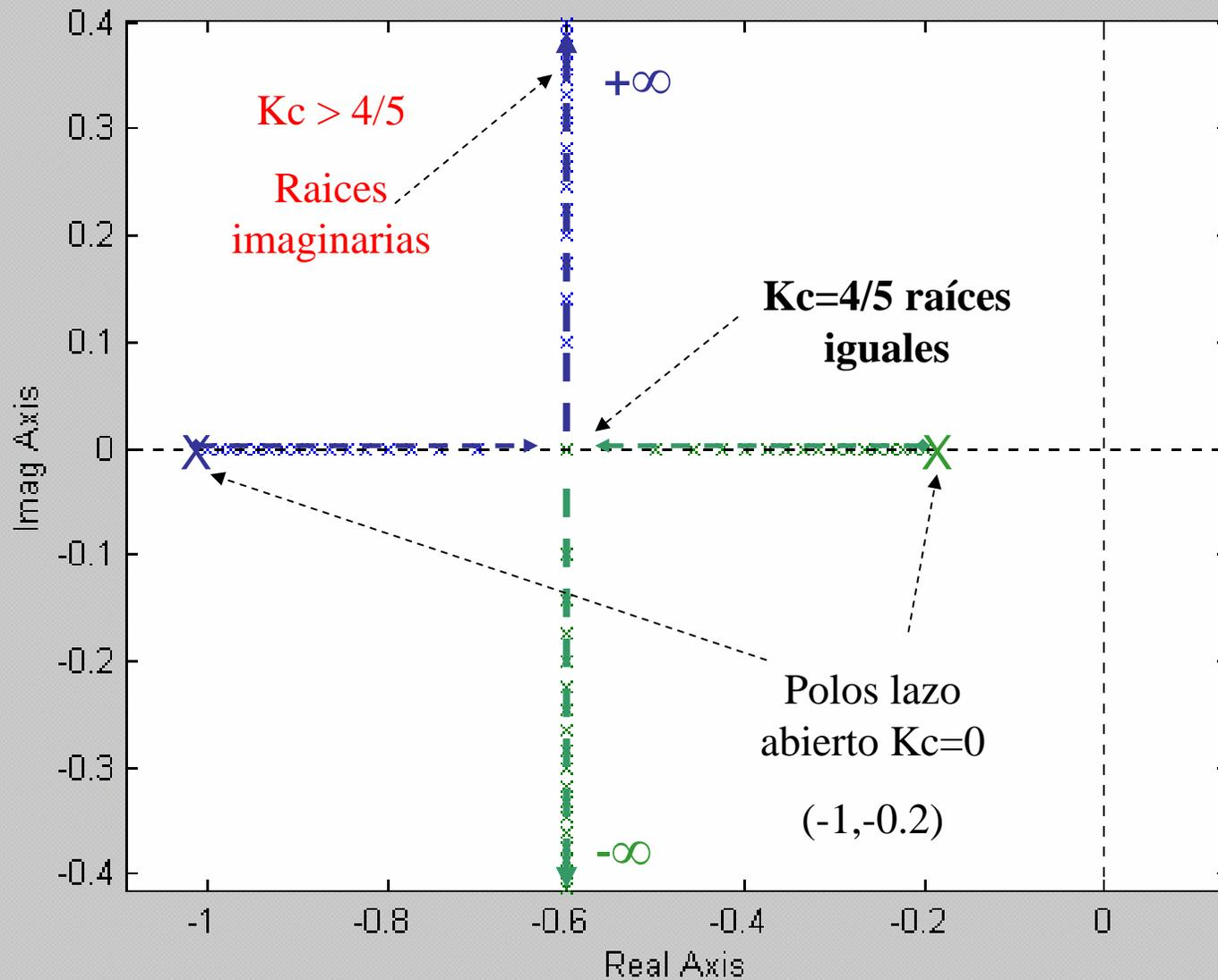
Efecto de la acción integral que aumenta el orden del sistema y la posibilidad de caer en la zona inestable (los lazos se mueven hacia la derecha). En este caso se ve que existe una cota máxima para el valor de  $K_c$ , (ultima ganancia) por sobre este valor, el sistema es inestable
